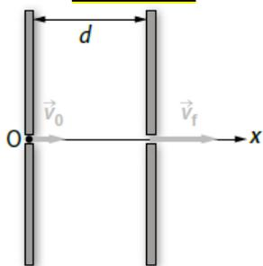
Une particule peut être accélérée linéairement si elle pénètre à l'intérieur du condensateur plan avec un vecteur vitesse perpendiculaire aux armatures. L'armature de sortie doit être de charge opposée à celle de la particule.
